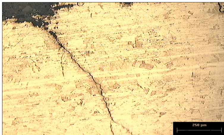
Figura 9.- Micrografia vista frontal da trinca na Zona Termicamente Afetada.
