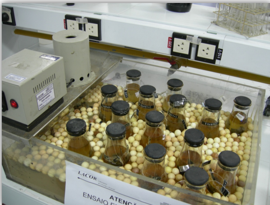
Banho termostático com circulação forçada
