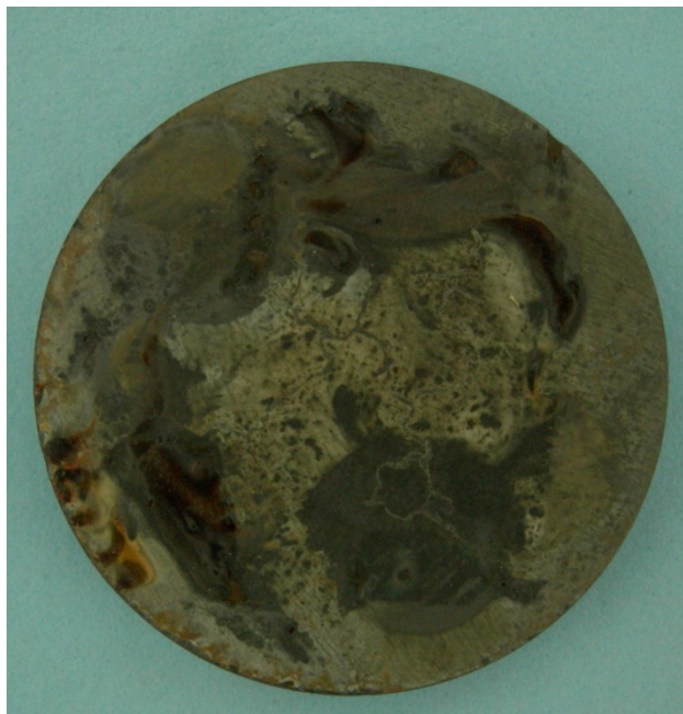
Antes da decapagem química – Filme de carbonato de ferro
