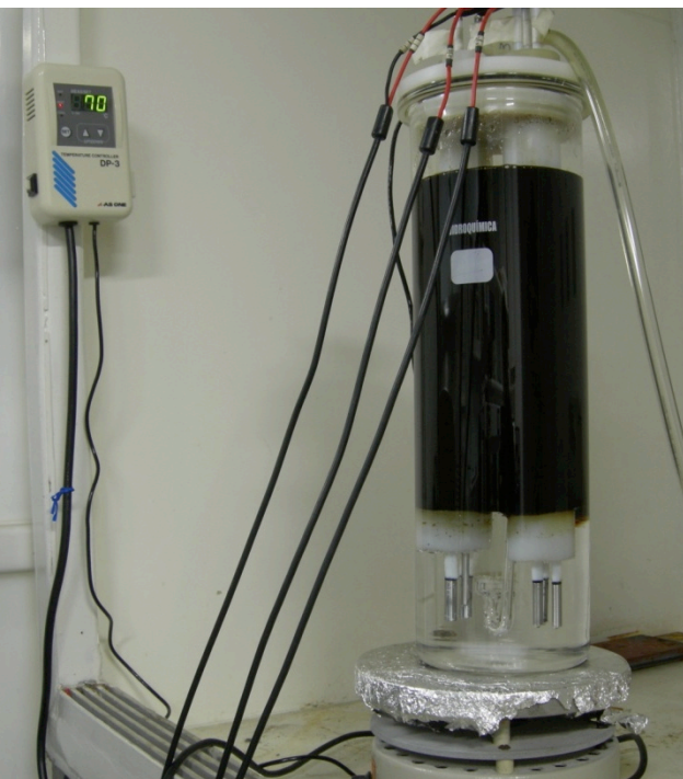
Montagem do ensaio Bubble Test
