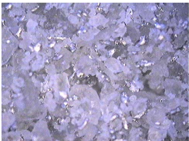
Figura 2. Morfologia da mistura com 30%Al e 70%PEMD (aumento de 50 vezes)
