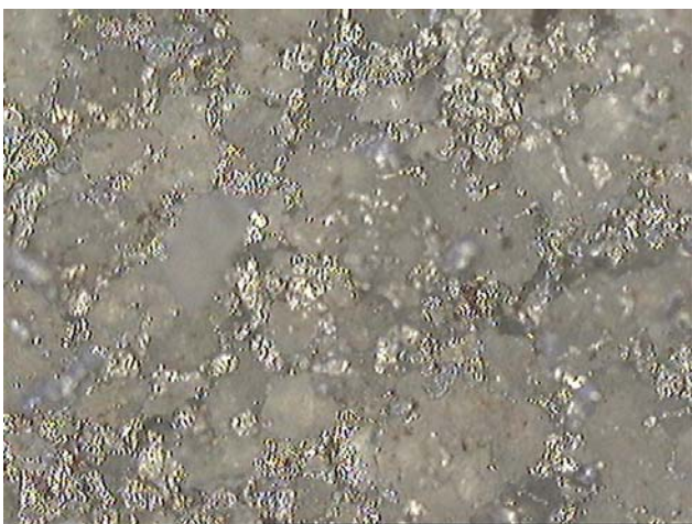
Figura 5. Morfologia da mistura com 70%Al e 30%PEMD compactada e submetida a aquecimento (aumento de 50 vezes)
