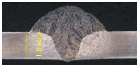
Figura 3.2.3 – Definição de penetração total.
