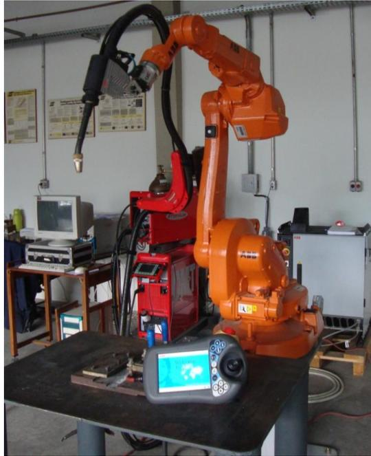
Figura 3.2.2 – Equipamentos utilizados –robô e fonte de soldagem
