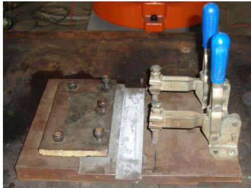
Figura 3.2.1 – Dispositivo de fixação.
