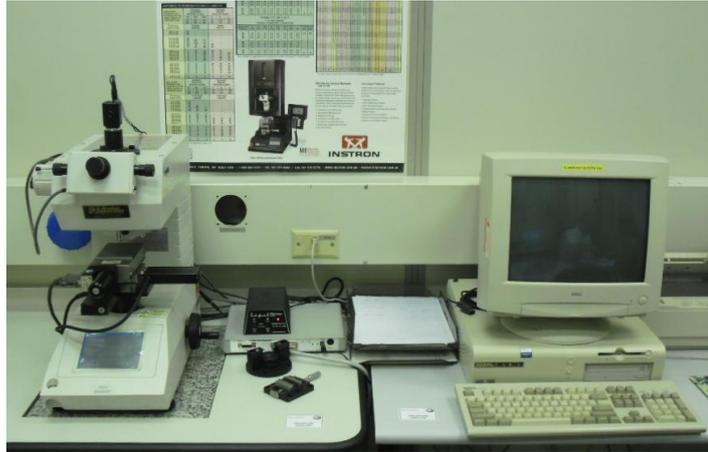
Figura 3.2.5 – Equipamento de medição de microdureza
