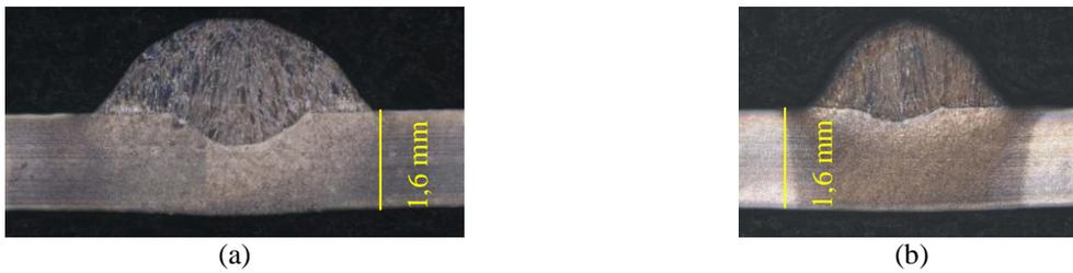
Figura 4.5.3.a – influência da velocidade de soldagem sobre a geometria do cordão, CMT e velocidade de soldagem de 10 mm/s.
