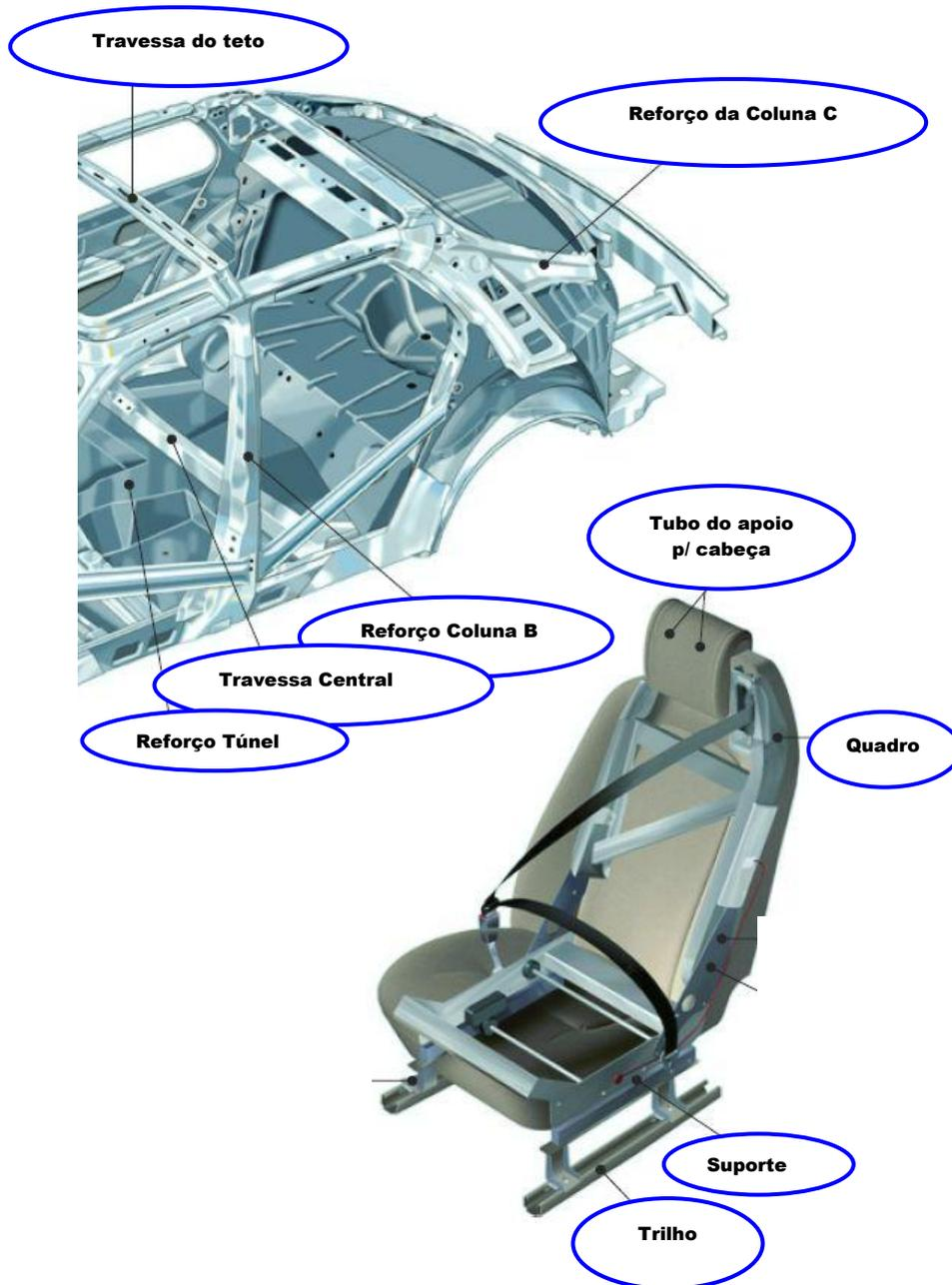
Figura 1.4.b – Aplicação do aço DP 600 na indústria automotiva – cortesia SSAB
