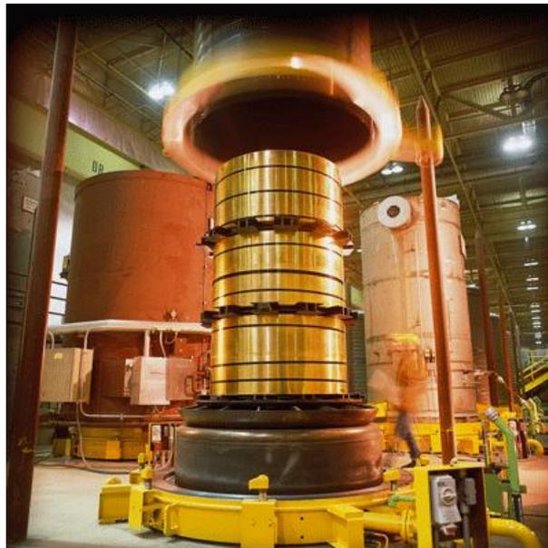
Figura – 2.1.3 Ilustração de forno de lote de recozimento - cortesia da SSAB
