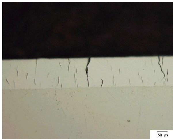
Figura 2 – Seção transversal do revestimento de cromo duro (200X)
