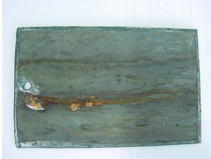
Figura 5 – Aspecto do revestimento A após 400h em névoa salina. Os pontos de corrosão vermelha surgiram nas primeiras 24h do ensaio.
