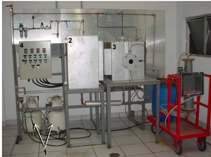
FIGURA 5. Vista geral do aparato experimental para ensaios de erosão-oxidação montado nos Laboratórios de Corrosão do IPEN/CNEN-SP, onde 1 são os compressores, 2 é o forno de pré-aquecimento, 3 é o forno de ensaios de erosão-oxidação e 4 é o painel de controle do motor e das zonas de aquecimento dos fornos.
