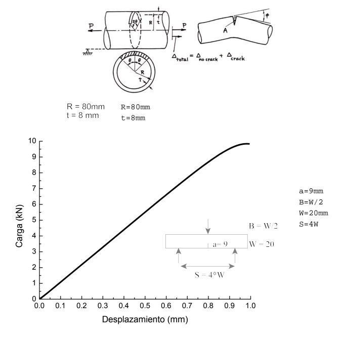
¿Es válido el valor de KIC obtenido en el ensayo?. Verificar todas las condiciones de validez del criterio  $K_{\rm IC}$ .
