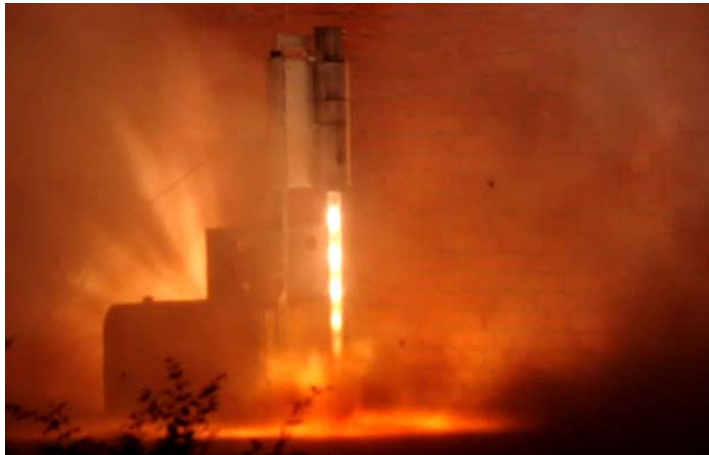
Figure 3: Motor do foguete SD-2 (1500 N) em ensaio estático de qualificação – fonte UnB.
