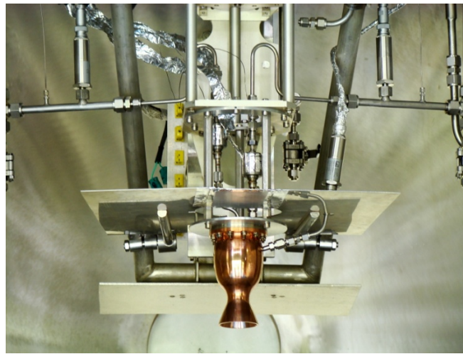
Motor de cobre de MMH e N 2 O 4 de 200 N para medidas de fluxo de calor.
