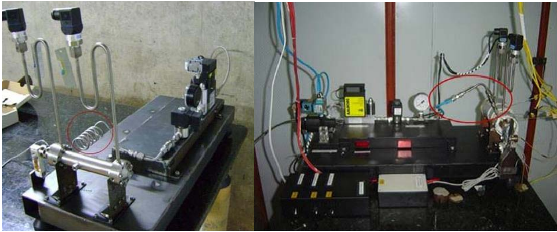
Figura 7 – Protótipo de propulsor termo-catalítico de N 2 O montado na balança de empuxo.
