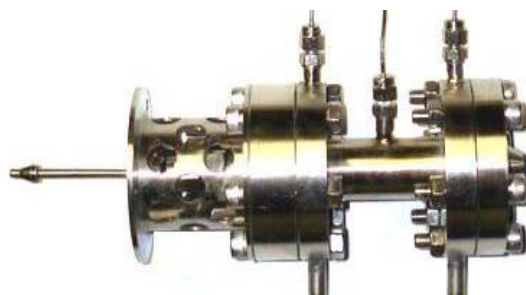
Propulsor monopropelente de peróxido de hidrogênio de 2N para testes de catalisadores.
