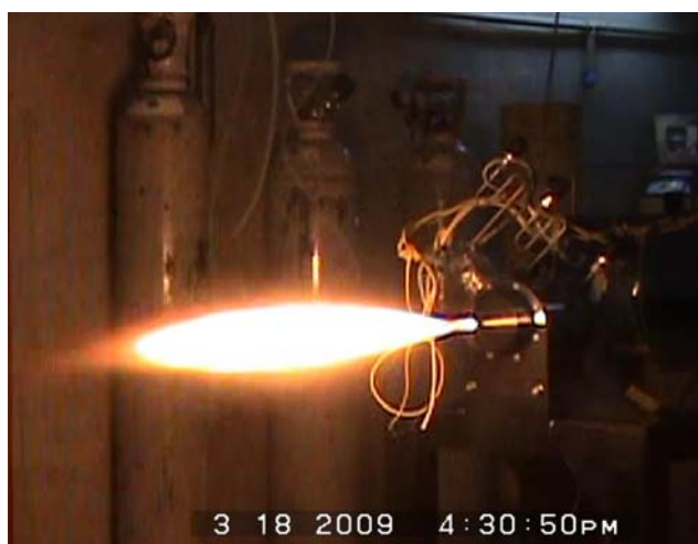
Motor-foguete híbrido de parafina e óxido nítrico.
