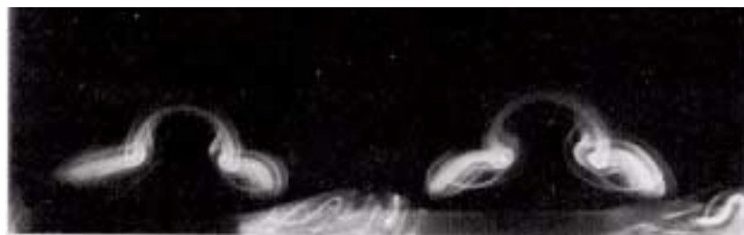
Figura 2.15 Secção transversal laser das instabilidades grampo de cabelo (3) visualizadas na Figura 2.14.
