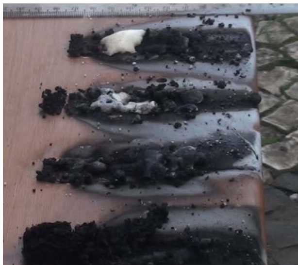
Figura 9. Resíduos deixados sobre a placa após a queima de quatro amostras
